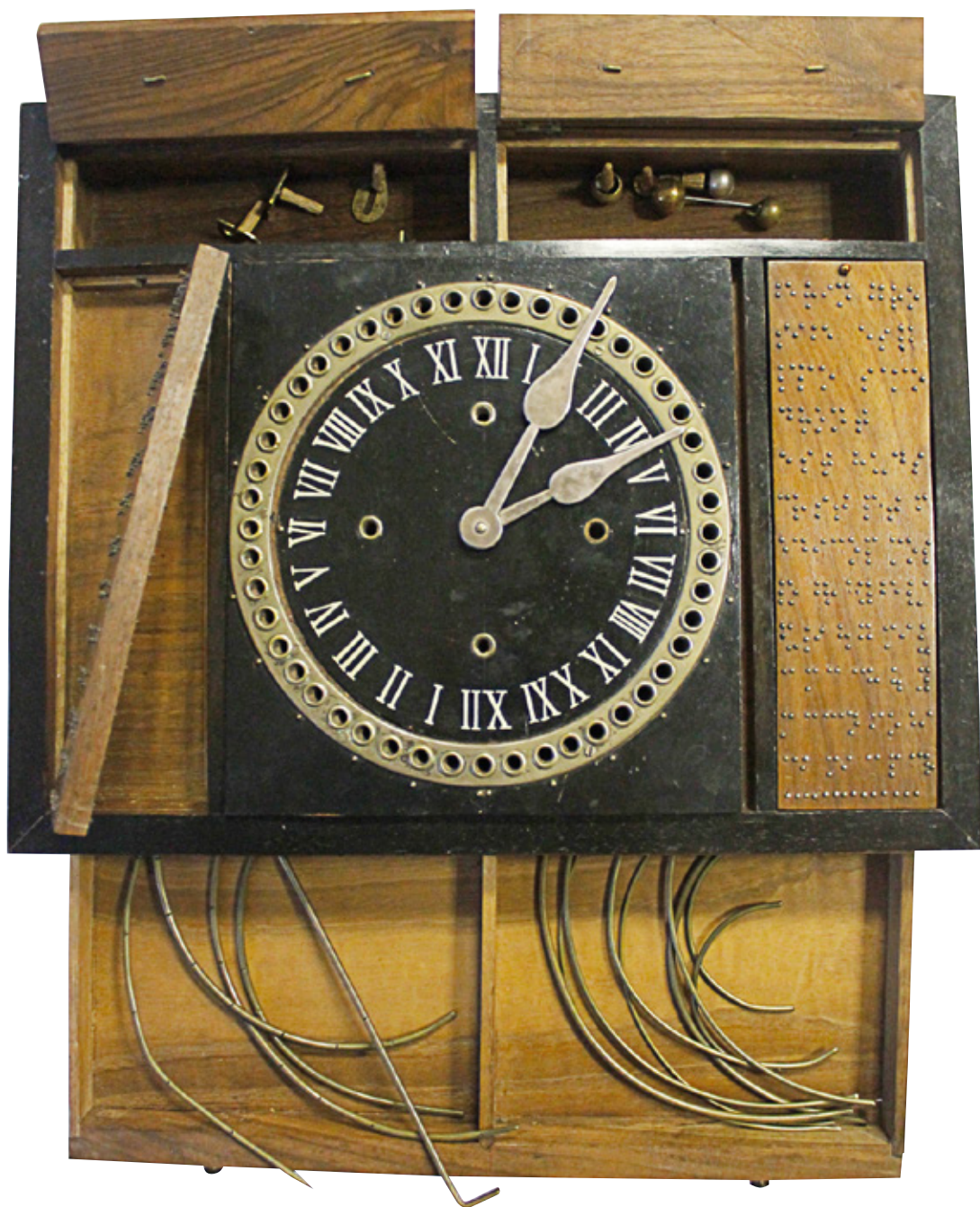
Astronógrafo Navalón. Invención de Manuel López Navalón para o ensino da mecánica celeste e o paso do tempo ás persoas cegas.
